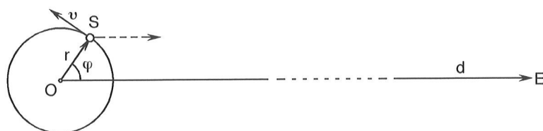
Abbildung 1: Ein Stern S kreist gleichmässig um ein Zentrum O und sendet Licht in Richtung Erde E. Die Kreisbahn hat Radius r, die Erde Abstand d \gg r . Der Polarwinkel \varphi des Sterns wächst proportional zur Zeit und zur Bahngeschwindigkeit v, genauer \varphi = v \cdot t' / r
